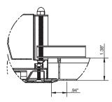
SCR (W/ OC FRAME) RECESSED GRID
